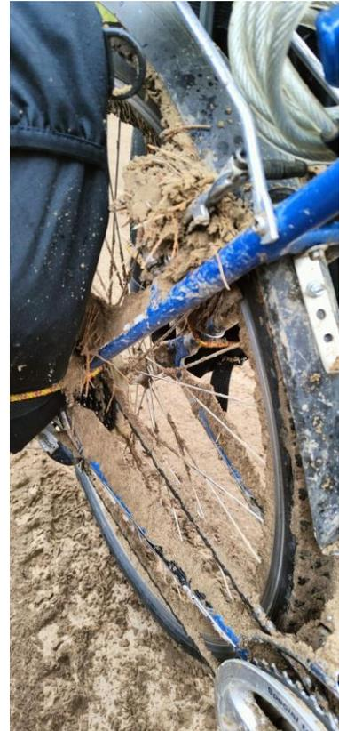
В дождливую погоду происходит обильное налипание песка на покрышки и отдельные элементы трансмиссии и тормозной системы велосипеда
